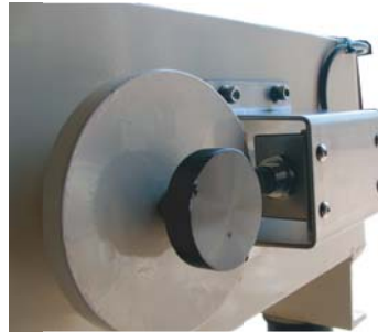
■ シャッター開閉棒及び開閉検知付 DL-***M-***7*
